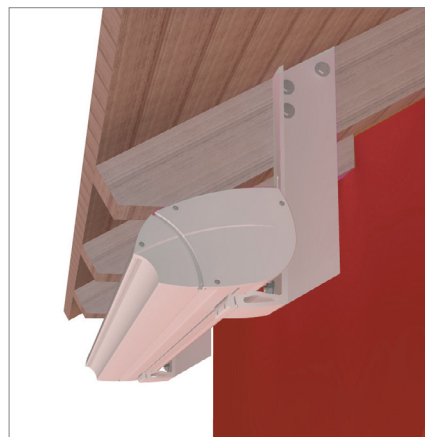
Montáž na střešní krovy
